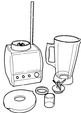
FIG n°10 - Macchina smontata per la pulizia
